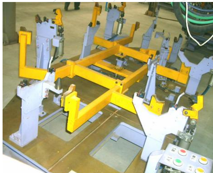
焊接夹具-保证焊接尺寸
