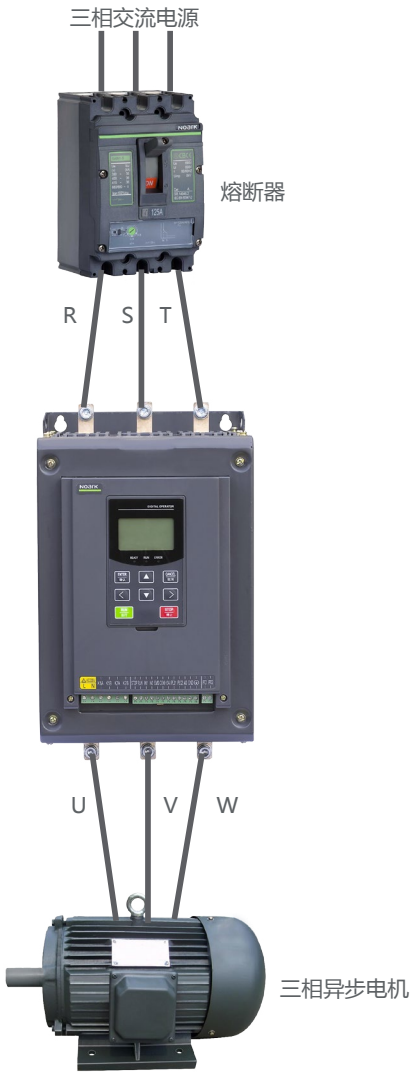
图2.6 基本接线示意图
